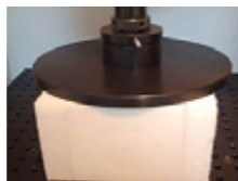
Pevnosť v tlaku \sigma_m = 255 \text{ kPa}
